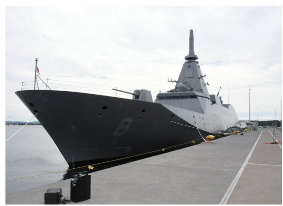
外部の各種装備品を内装することでスマートな外観となったほか、ステルス機能を強化した最新鋭の護衛艦です
